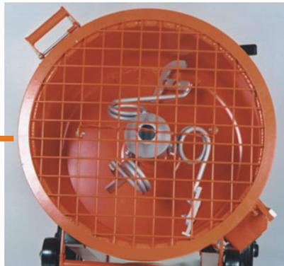
Die Mischarmee lassen sich leicht und ohne Werkzeug abnehmen. Dadurch ist eine schnelle Reinigung gewährleistet.
