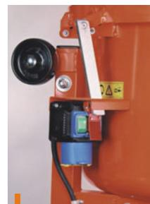
Der zentrale Betriebsschalter ist mit einer Schnellstopptaste und einer Sicherheitsabschaltung für den Trommeldeckel versehen.
