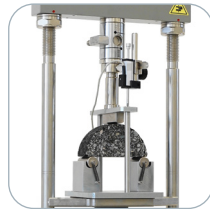
SCB - Semi-Circular Bend
